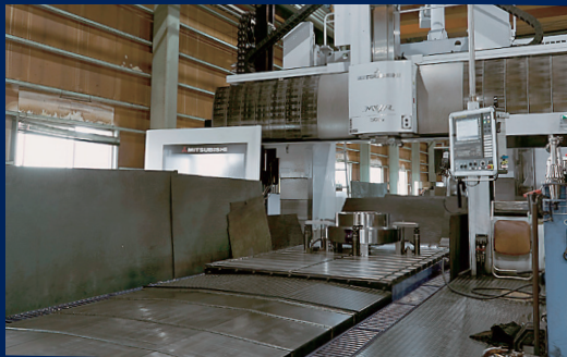
大型の精密部品も加工できる門形五面加工機
