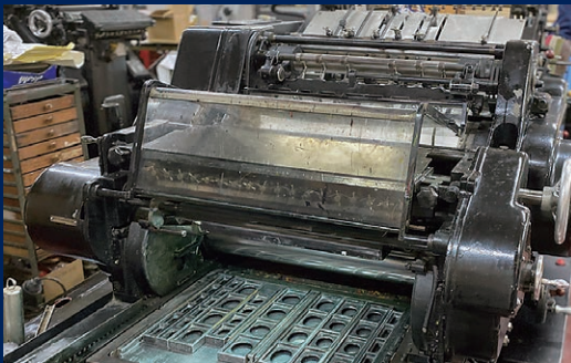
さまざまな形の抜き加工も可能な凸版印刷機
